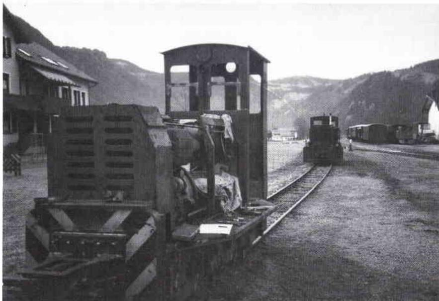
**16. August 1989:** Seit Oktober 1988 befindet sich mit der "sehr instandsetzungswürdigen", 8 Tonnen schweren und 50 PS starken Diesellok der "Jenbacherwerke", Baujahr 1962, die dritte Diesellokomotive des Vereines in Bezaus. Die ehemals zum Werksverschub im Betriebsgelände der Fa. "Schöllner-Bleckmann" in Ternitz - Niederösterreich -
