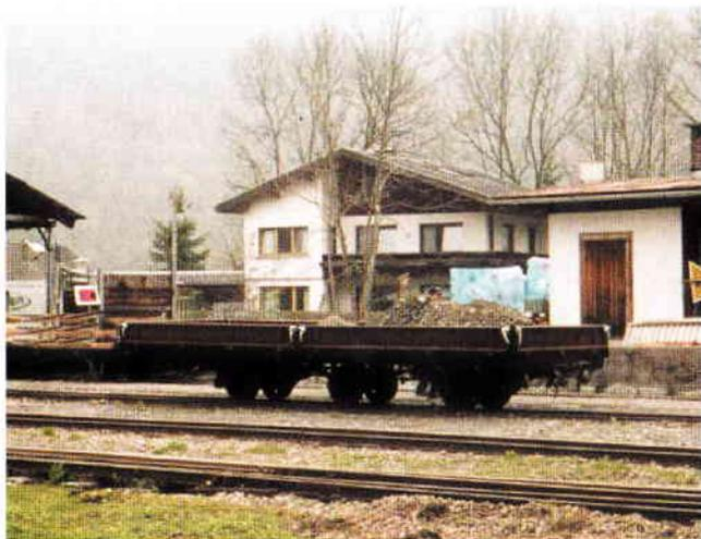
Der neue Niederbordwagen - BWB 223. Aus dem Hochbordwagen (O/s 61580) der Mariazellerbahn ist in der Werkstätte der Fa. Meusbürger Fahrzeugbau ein moderner und robuster Arbeitswagen mit kippbaren Metallbordwänden und Blechboden geworden.
