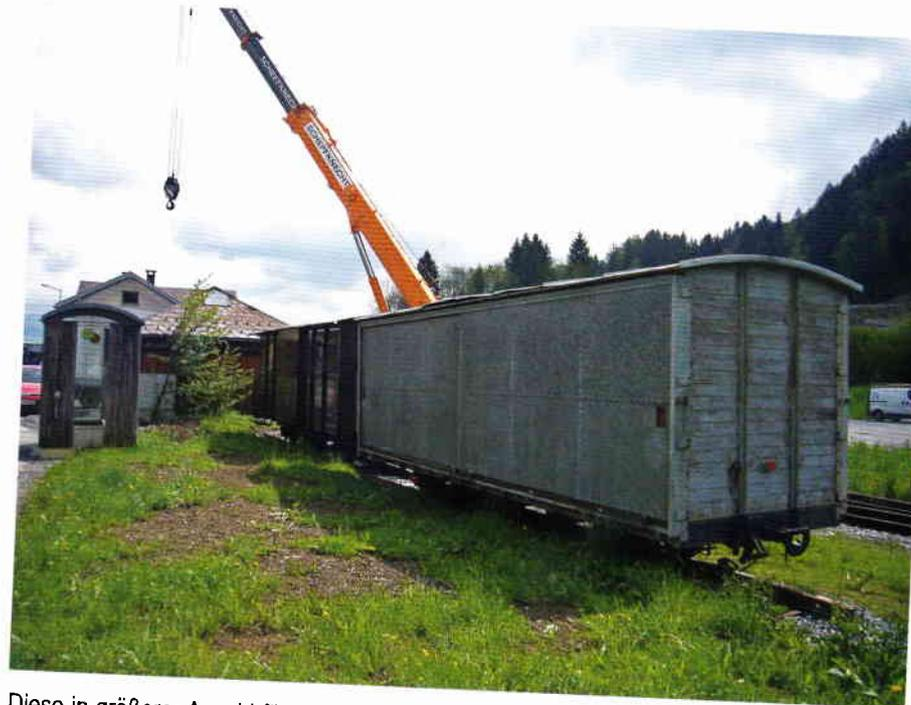
Diese in größerer Anzahl für den Talkumtransport auf der Feistritzalbahn gebauten Wagen zeigen eine der Möglichkeiten auf, wie auf Schmalspurbahnen ein relativ rationeller Gütertransport abgewickelt werden könnte.
