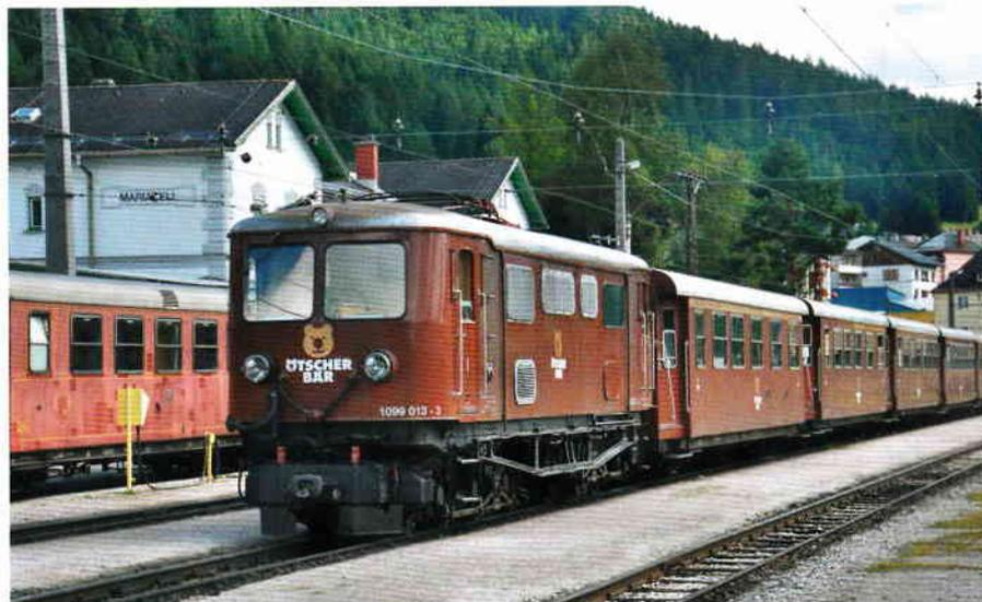
Die Maschine gehört zur weltweit ältesten regelmässig im Alltagsbetrieb fahrenden E-Lok-Serie! Die zweimotorigen Maschinen leisten rund 600 PS, die Fahrleitungsspannung beträgt 6500 Volt.
