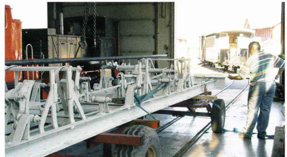
**Das Fahrgestell des neuen Wagens stammt von einem Güterwaggon der Mariazellerbahn und wurde von Grund auf an seine neue Verwendung angepasst**
