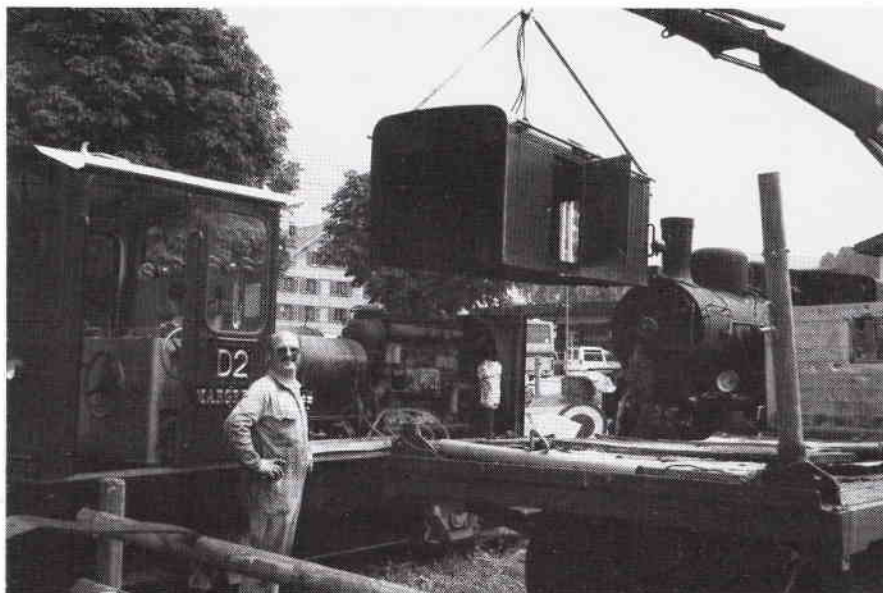
Diesellok "Margreth" bei der Vorbereitung zur Motorüberholung.
